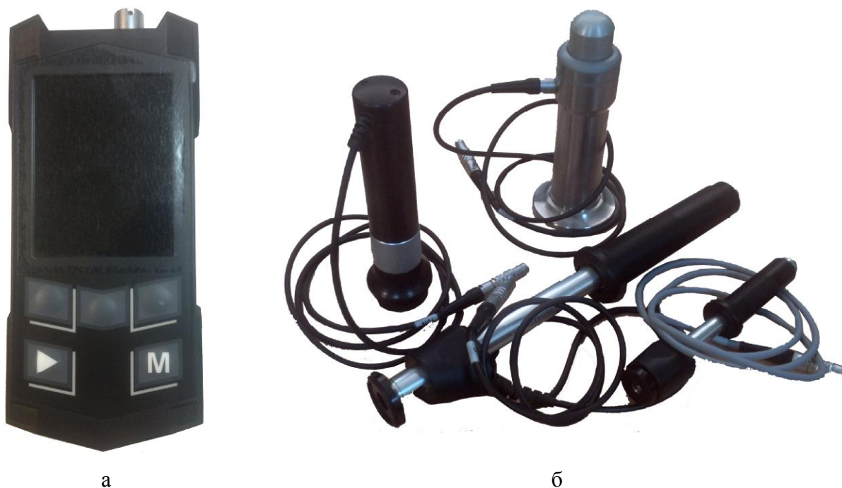
Рисунок 1 - Общий вид электронного блока твердомера (а) с комплектом сменных преобразователей (б)
