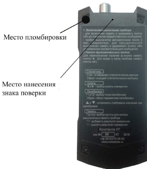
Рисунок 2 - Схема пломбировки от несанкционированного доступа, обозначение места нанесения знака поверки
