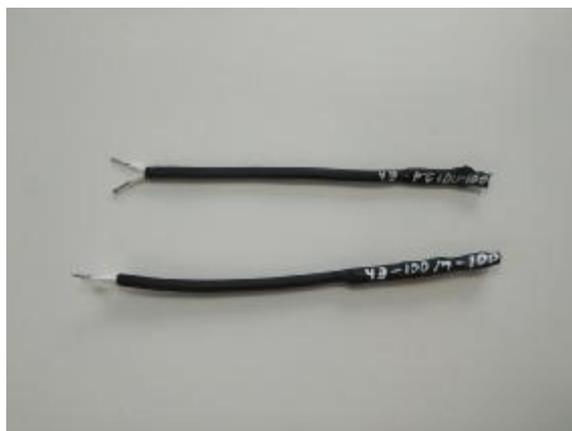
Рисунок 4 – Общий вид ТСМ-ЧЭ, ТСП-ЧЭ
