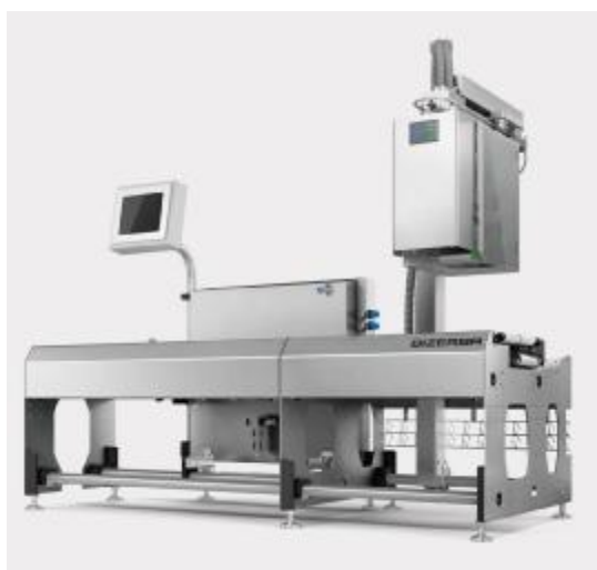
GLM-I (GLM-Ievo, GLM-Ievo 70) с устройством для этикетирования (нанесение этикетки сверху)
