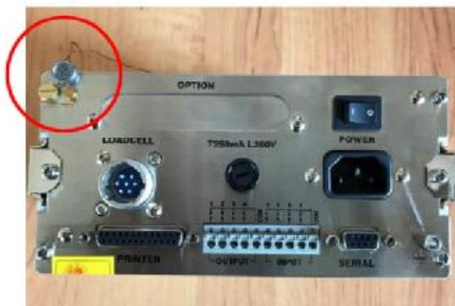
Рисунок 2 – Схема пломбировки CI-5010А от несанкционированного доступа
