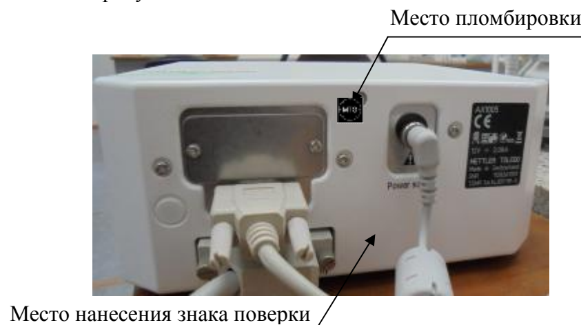
Рисунок 4 – Схема пломбировки от несанкционированного доступа, обозначение места нанесения знака поверки на модуль управления
