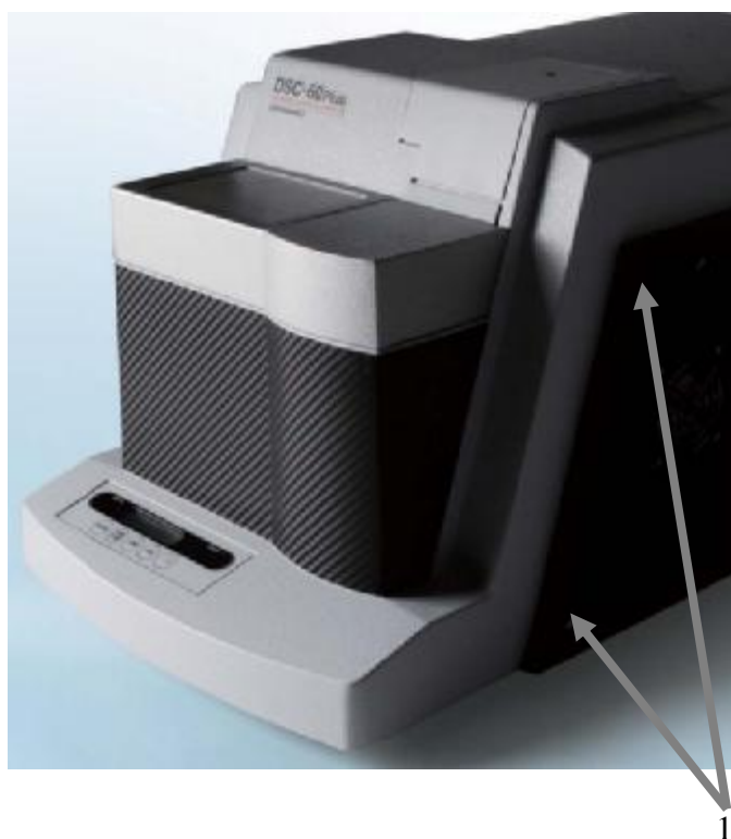
Рисунок 3 – Схема пломбирования калориметров дифференциального сканирующего модификаций DSC-60 Plus, DSC-60A Plus
