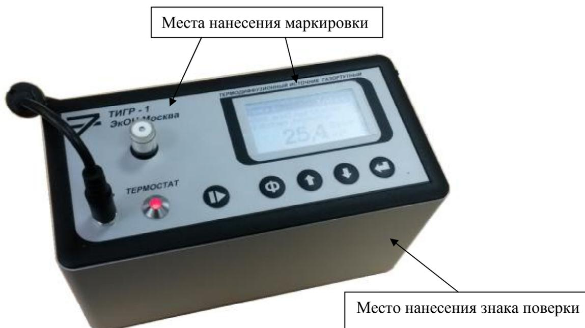
Рисунок 1 - Общий вид источников газортутных с указанием мест нанесения маркировки и места нанесения знака поверки
