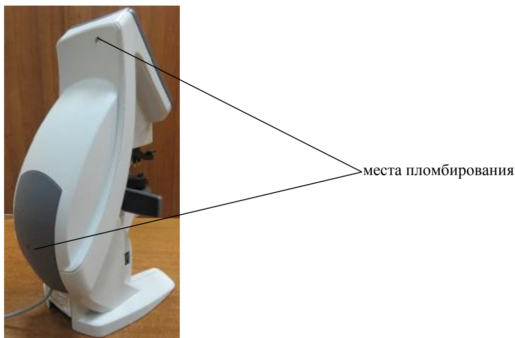
Рисунок 2 – Схема пломбирования линзметров ЛЭМ -1 от несанкционированного доступа
