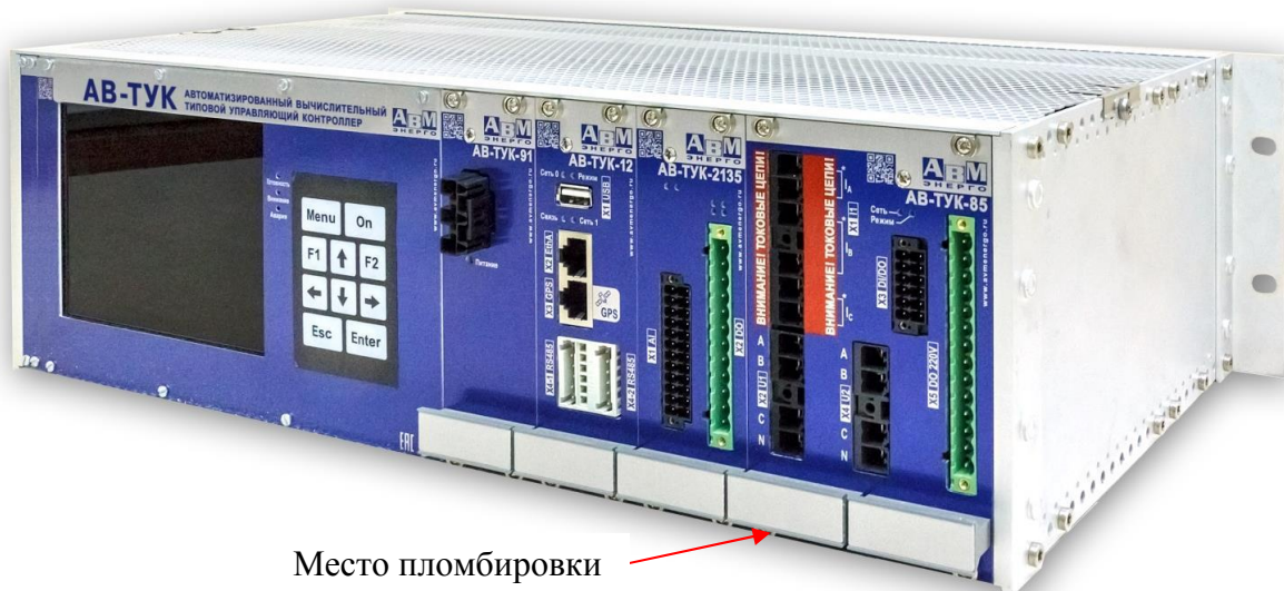
Рисунок 1 - Общий вид контроллера (однокрейтовое исполнение) и обозначение места пломбировки от несанкционированного доступа
