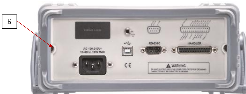
Рисунок 2 – Схема пломбировки от несанкционированного доступа (Б)
