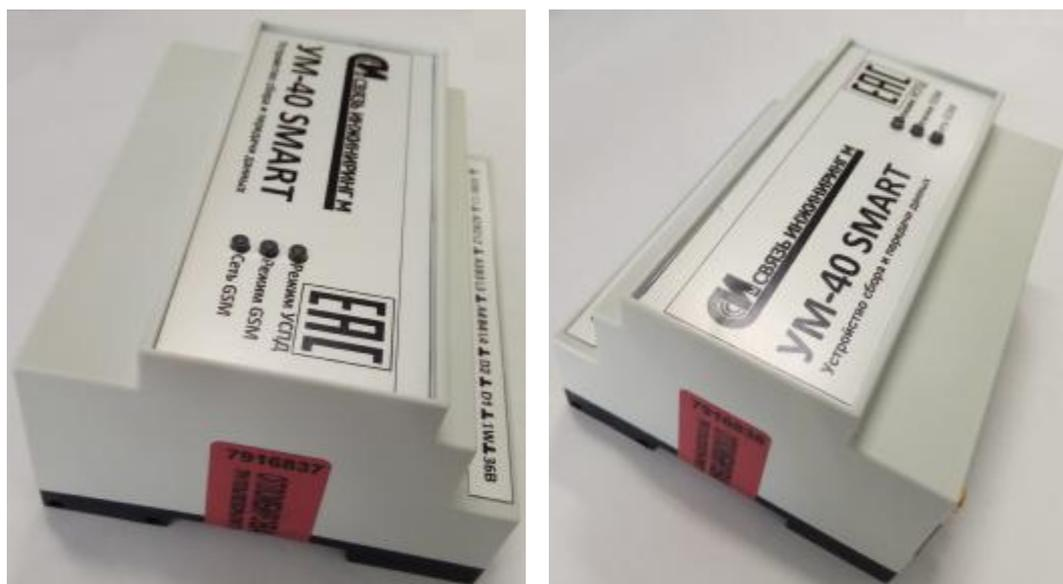
Рисунок 2 – Места нанесения пломбирочных наклеек на боковые поверхности устройства
