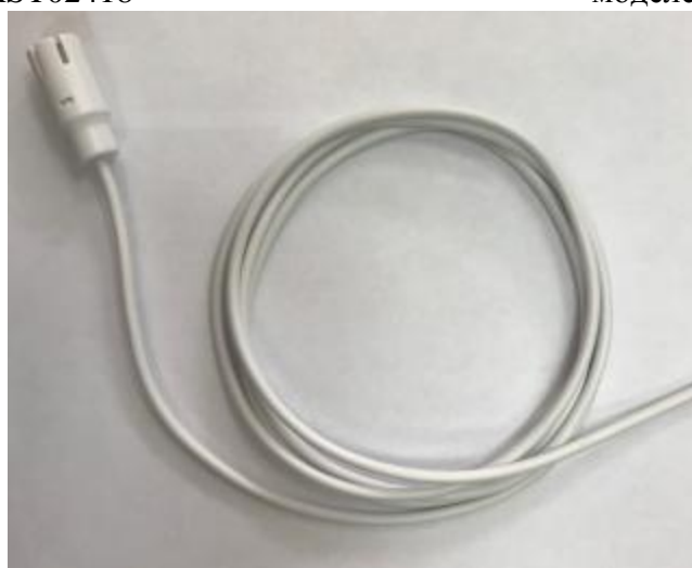
Рисунок 5 – Общий вид внешнего датчика температуры и относительной влажности модели RST02218
