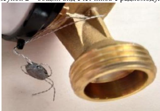
Рисунок 3 – Пломбировка
