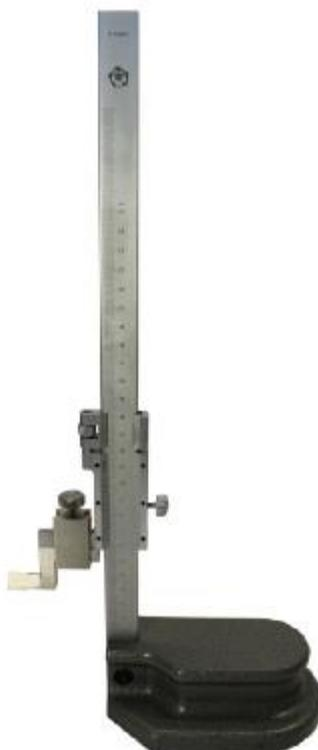
Рисунок 1 – Общий вид штангенрейсмасов ШР
