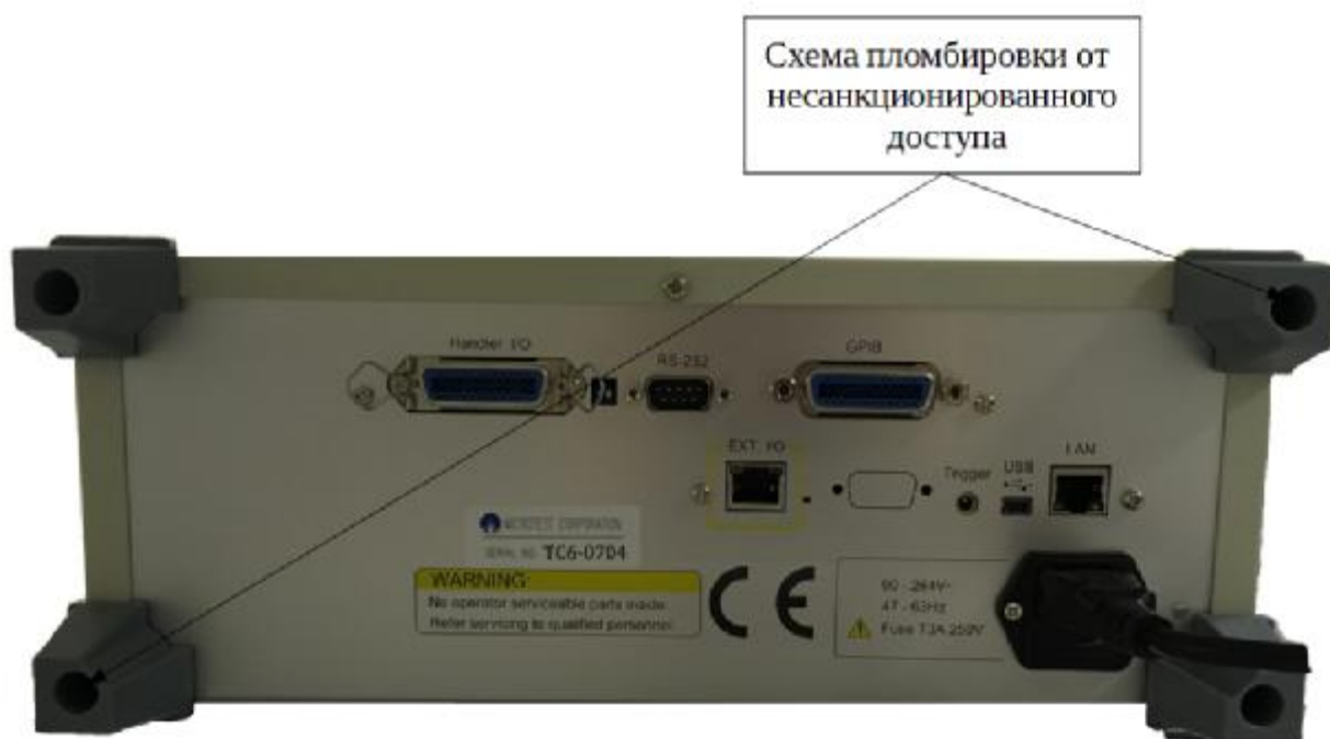
Рисунок 2 — Схема пломбировки от несанкционированного доступа
