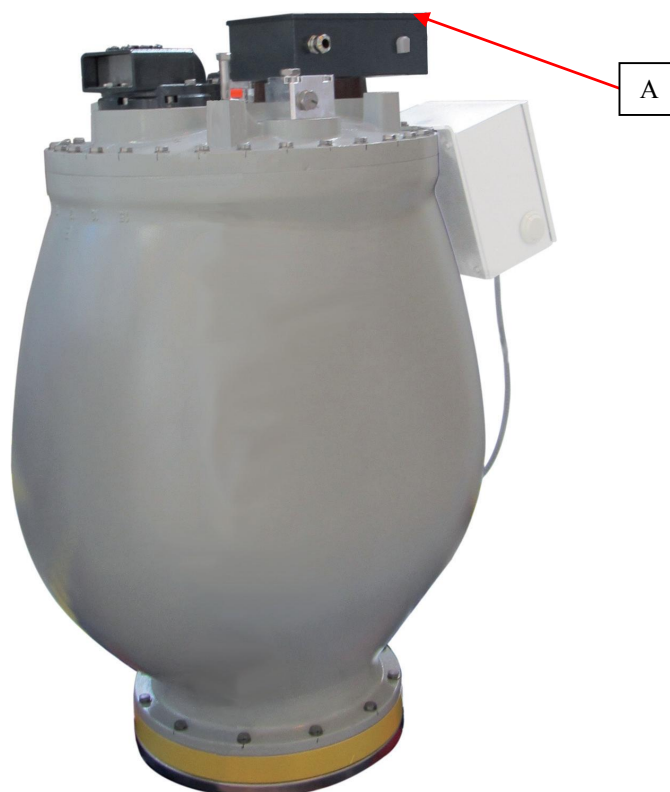
Рисунок 1 – Общий вид средства измерений и обозначение места пломбировки от несанкционированного доступа (А)
