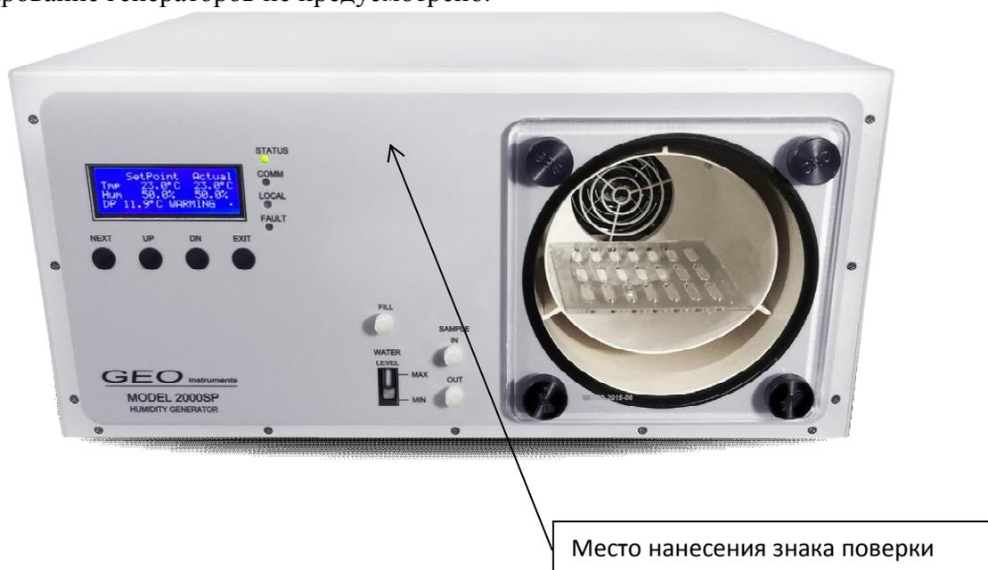
Рисунок 1 - Внешний вид генератора и обозначение места нанесения знака поверки
