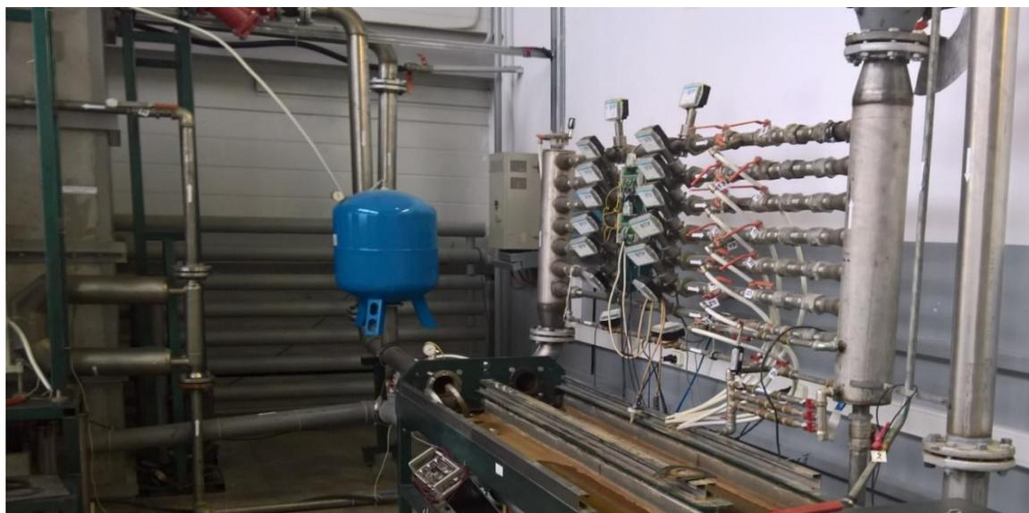
Рисунок 1 – Общий вид установки поверочной СПРУТ 100М
