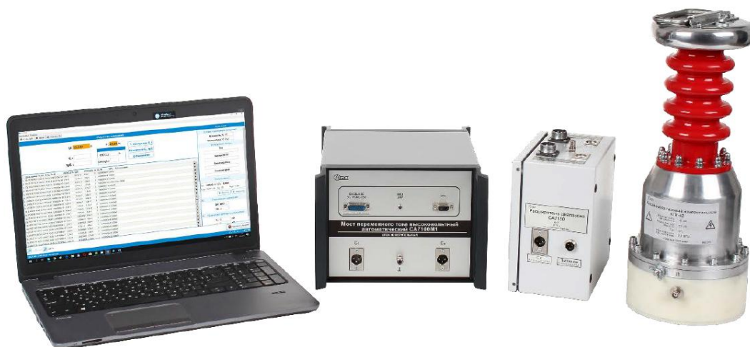
Рисунок 1 – Общий вид моста СА7100М1 с расширителем диапазона СА7150, эталонным конденсатором и ноутбуком
