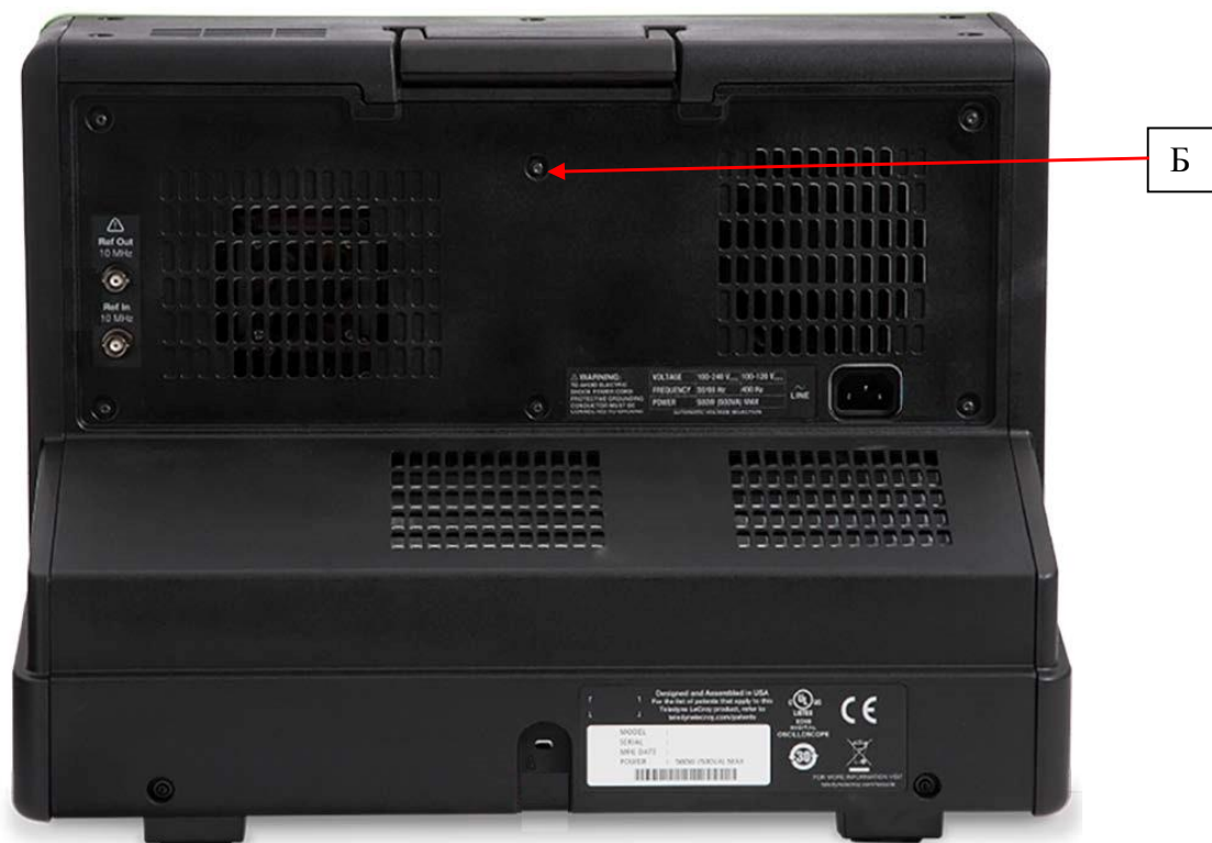
Рисунок 2 – Схема пломбировки от несанкционированного доступа (Б)
