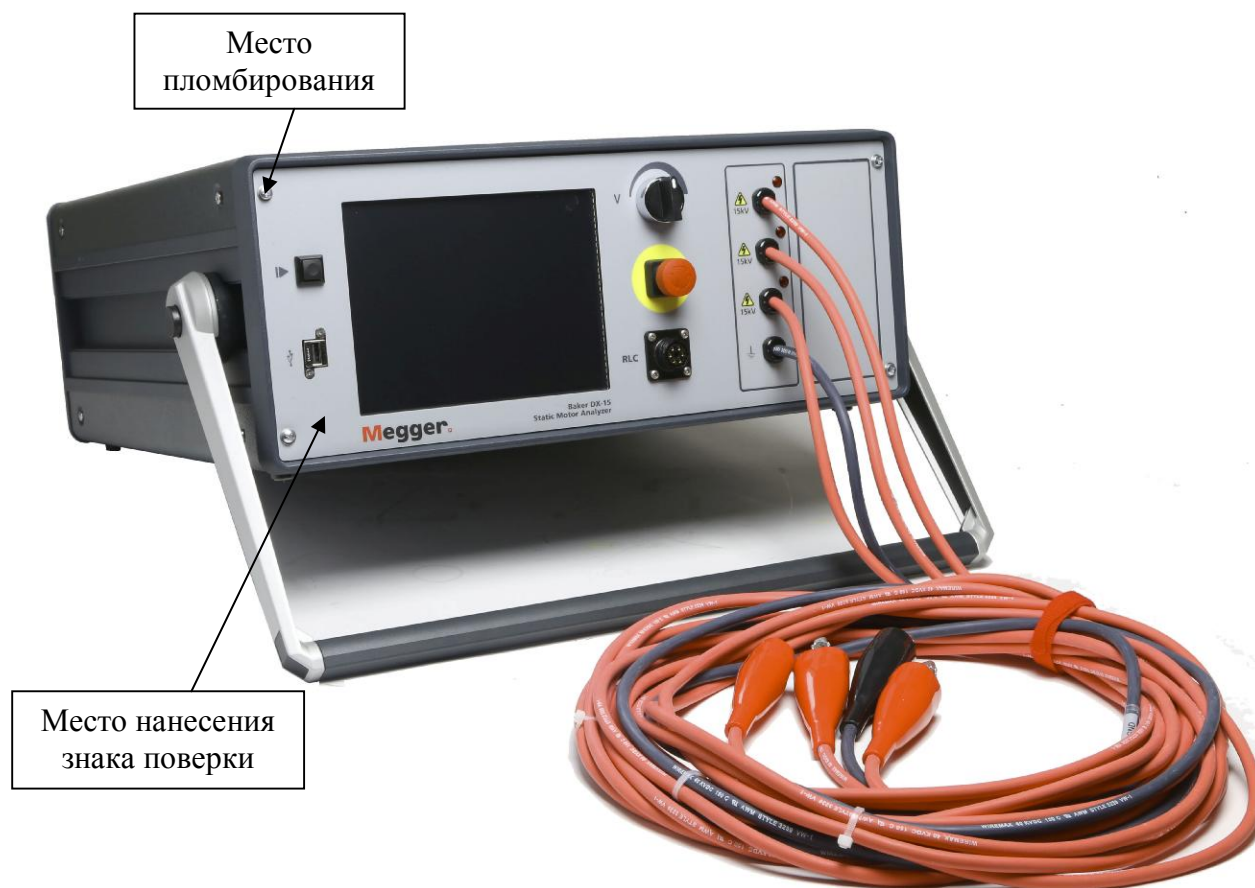
Рисунок 2 – Общий вид анализаторов модификаций DX15, DX15A с указанием места нанесения знака поверки и места пломбирования от несанкционированного доступа
