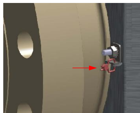
Рисунок 4 – Схема установки пломб от несанкционированного доступа на блоке электроники преобразователя модели 3812
