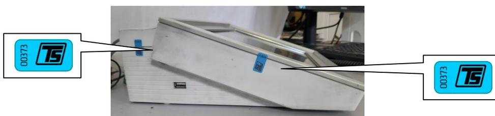
Рисунок 2 – Схема пломбировки пульта оператора от несанкционированного доступа
