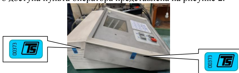
Рисунок 2 – Схема пломбировки пульта оператора от несанкционированного доступа
