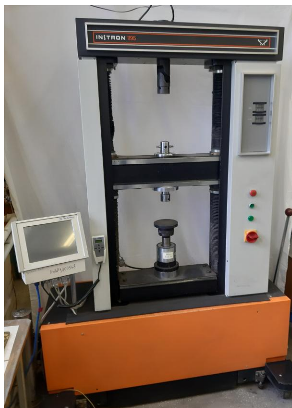
Рисунок 1 – Общий вид машины универсальной испытательной INSTRON 1195-M
