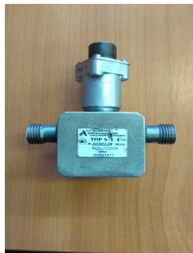
Рисунок 11 – Турбинный преобразователь расхода ТПР-5
