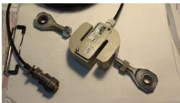
Рисунок 14 – Датчик весоизмерительный тензорезисторный С2А-0,1-С1 (из комплекта ТВЭУ-01П)
