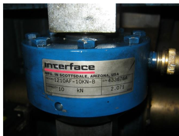
Рисунок 15 – Датчик тензометрический 1210AF-10KN-B в составе динамометра Froude-Hofmann HS-2600
