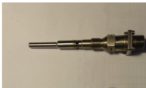
Рисунок 9 – Термопреобразователь сопротивления П-109
