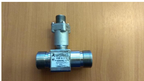
Рисунок 12 – Турбинный преобразователь расхода ТПР-8
