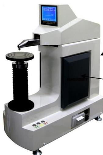
Рисунок 6 – Общий вид твердомеров TP 5008ПА Tochline, TPC 5009ПА Tochline
