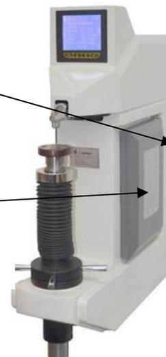
Рисунок 7 – Общий вид твердомеров TP 5008A Tochline
