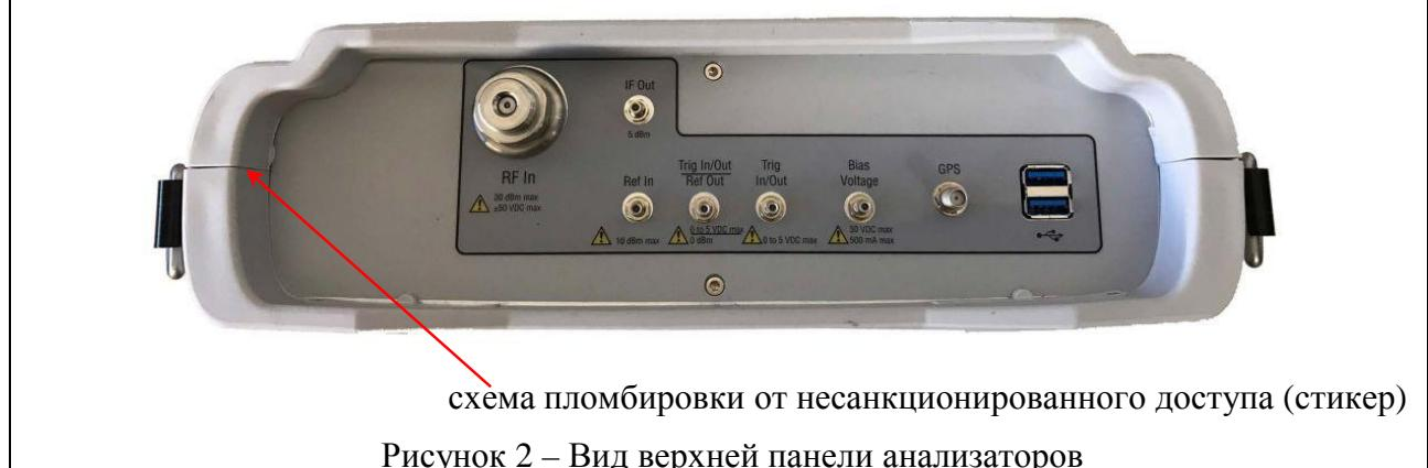
Рисунок 2 – Вид верхней панели анализаторов
