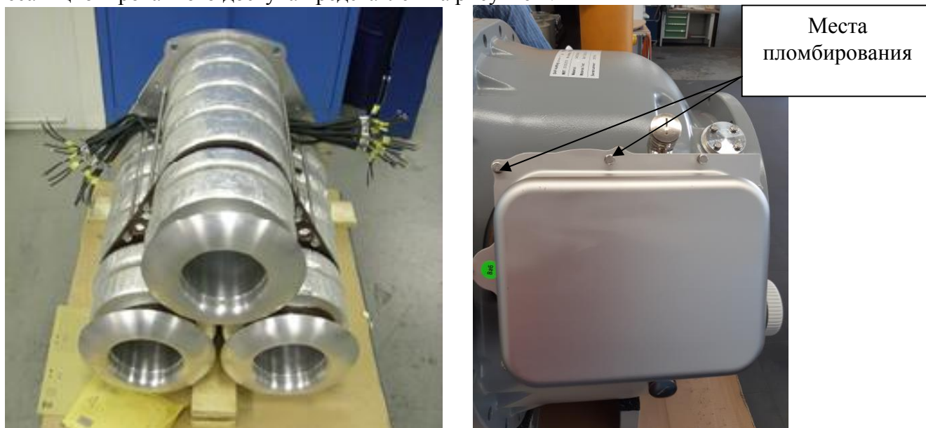
Рисунок 1 – Общий вид трансформаторов с указанием мест пломбирования от несанкционированного доступа
