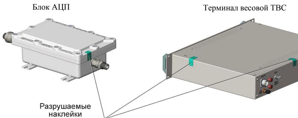
Рисунок 2 – Схема пломбировки блока АЦП и ТВС
