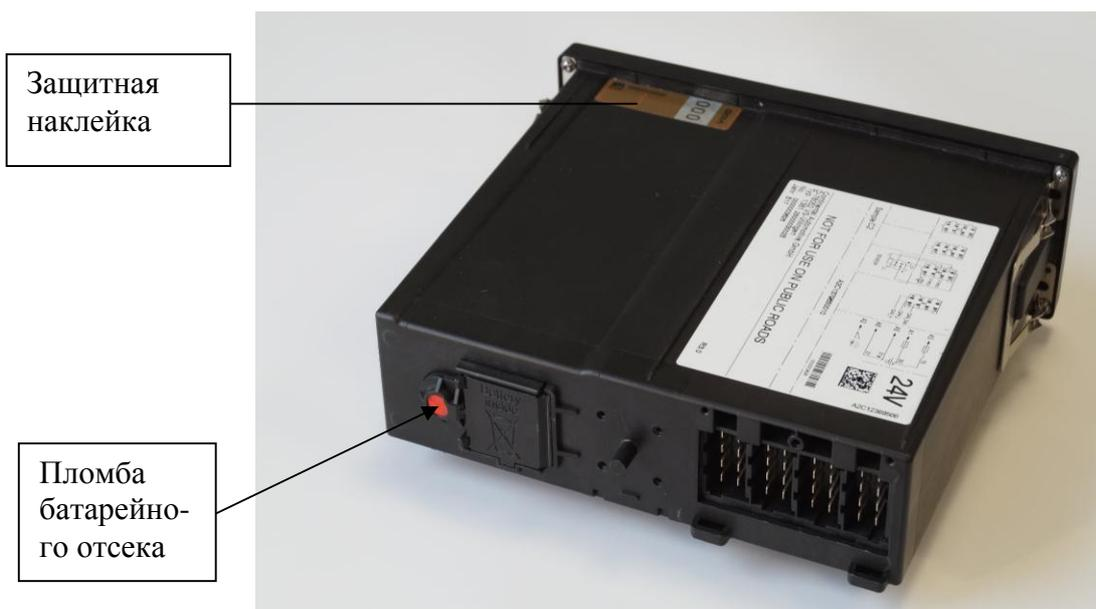
Рисунок 2 – Место нанесения защитной наклейки.
