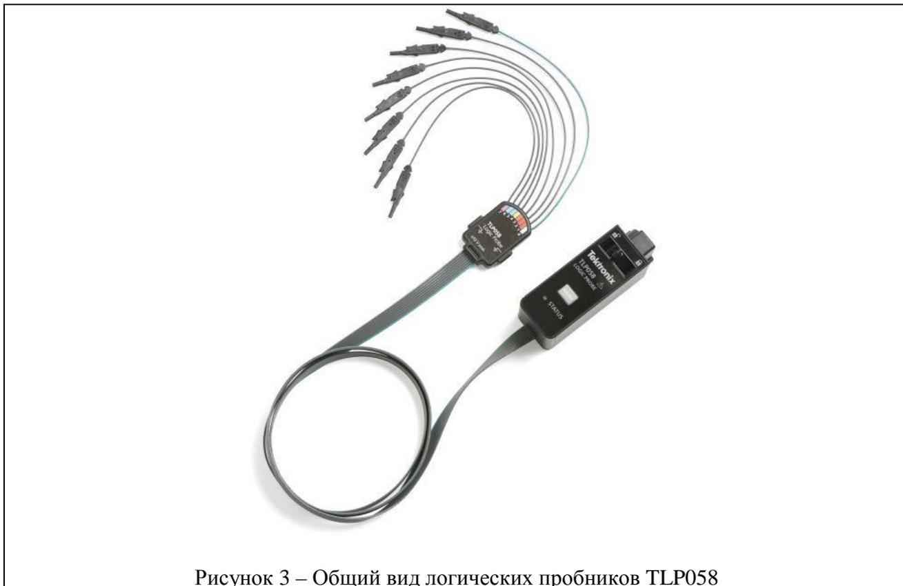
Рисунок 3 – Общий вид логических пробников TLP058
