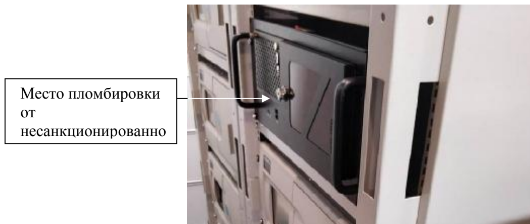
Рисунок 5 - Схема пломбировки от несанкционированного доступа
