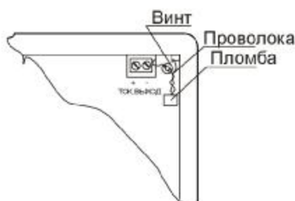
Рисунок 3 – Схема пломбировки вторичного преобразователя при креплении в щит.
