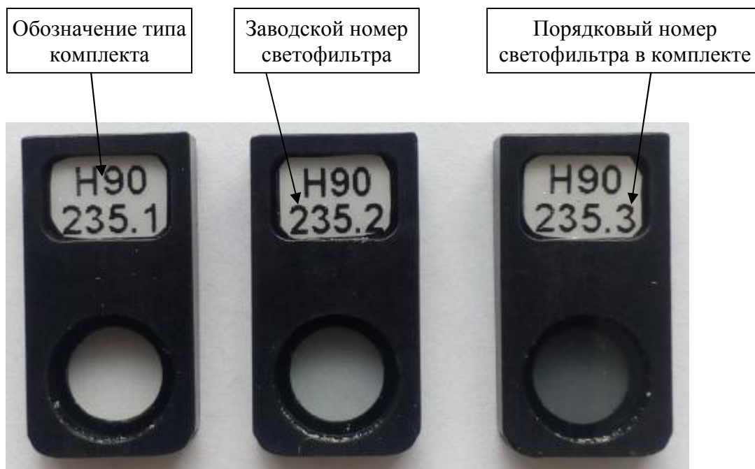
Рисунок 1 - Общий вид комплекта светофильтров Н90
