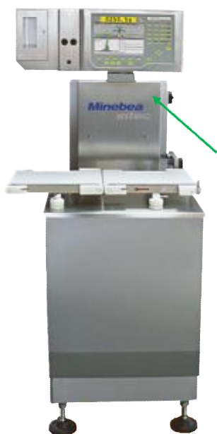
Рисунок 1а – Весы с компьютерным терминалом EWK30
