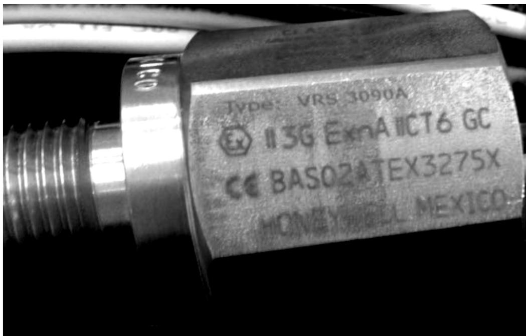
Рисунок 1 - Общий вид датчиков частоты вращения VRS модели 3090A
