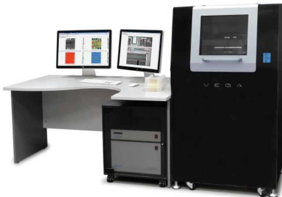
Рисунок 1 – Внешний вид микроскопов сканирующих зондовых VEGA (ВЕГА)
