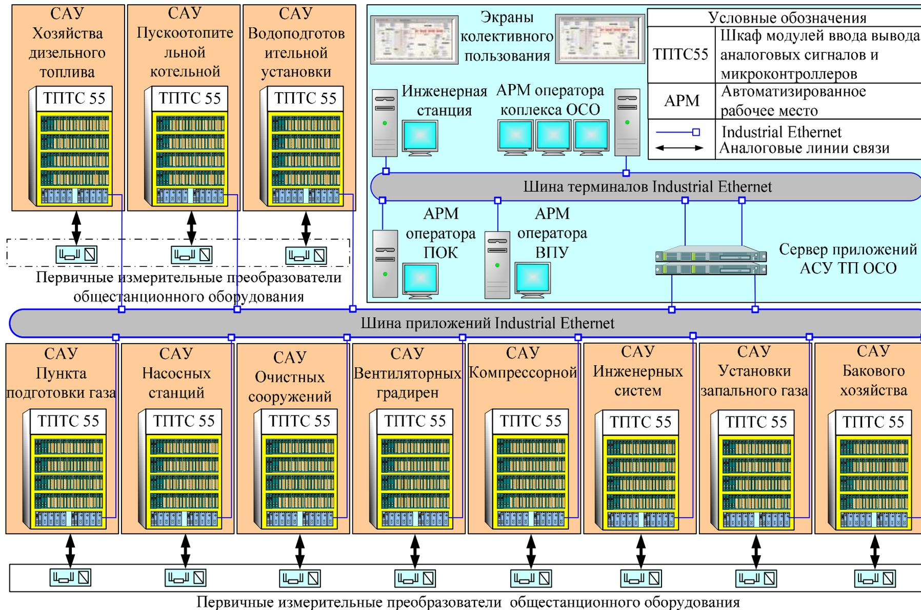
Рисунок 1 - Схема комплекса автоматизированного измерительно-управляющего "КИ-ОСО ПГУ Тамань-2"
