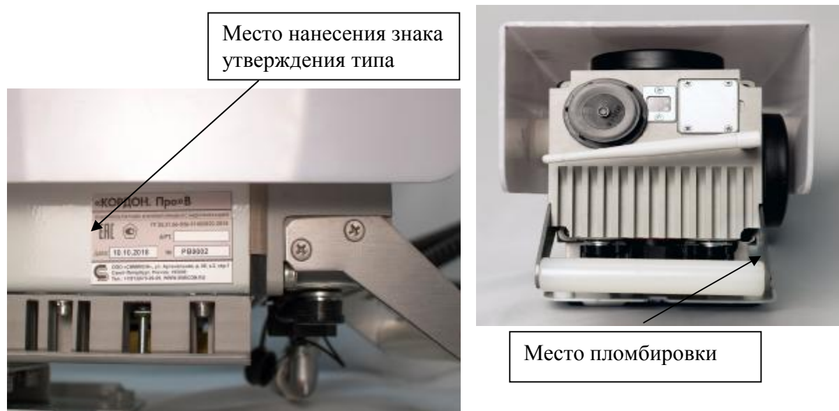
Рисунок 2 — Места пломбирования и нанесения знака утверждения типа
