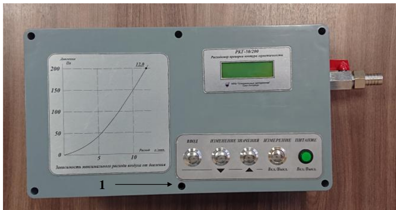
Рисунок 1 – Общий вид расходомеры проверки контура герметичности РКГ-50/200 1 – пломба
