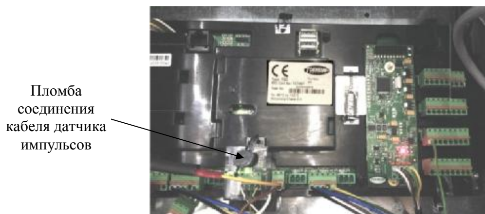
Рисунок 13 – Внешний вид и схема пломбировки платы EST контроллера TQC (для одно-продуктовых установок)
