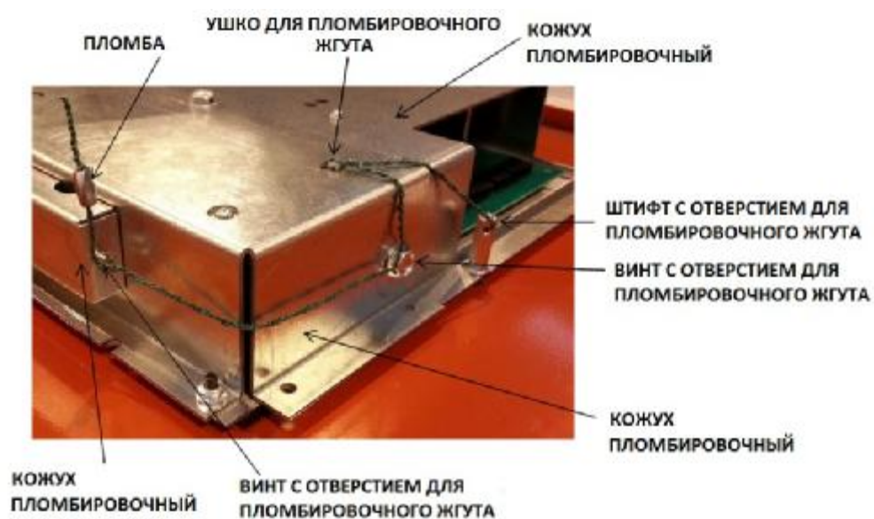
Рисунок 7 – Пломбировка механического сумматора учета
