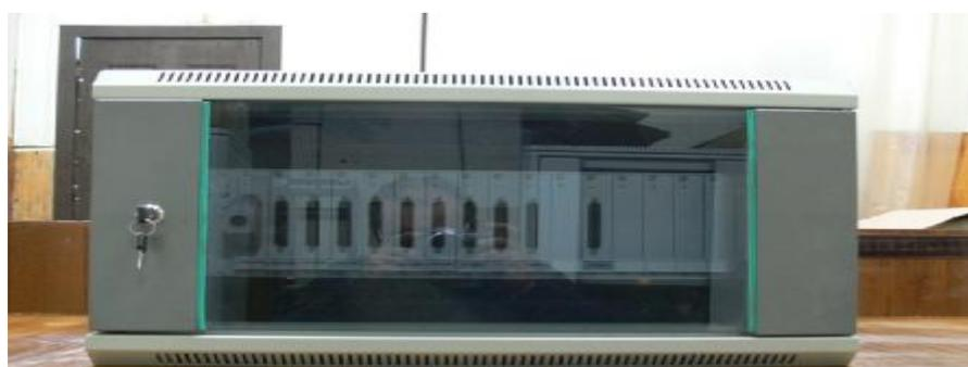
Рисунок 2 – Шкаф измерений (до 16 модулей)
