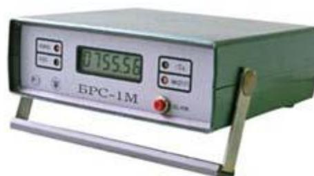
Рисунок 11 - Барометр рабочий сетевой БРС-1М-1
