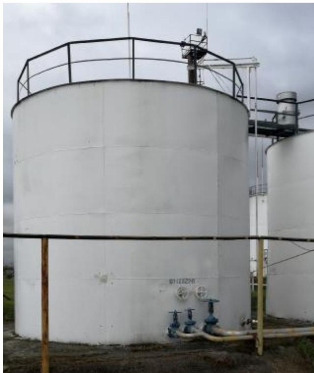
Рисунок 1 – Общий вид резервуара вертикального стального цилиндрического РВС-200,
