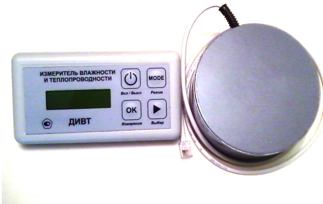
Рисунок 1 - Общий вид средства измерений. Блок вторичного преобразования сигнала (справа) и первичный измерительный преобразователь – датчик (слева)
