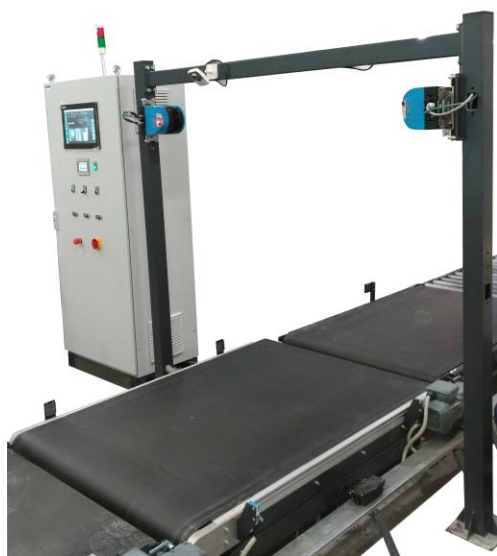
средство измерений с модулем измерений габаритных размеров и шкафом управления
