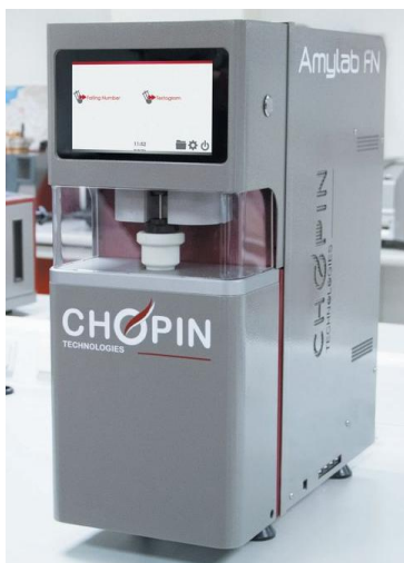
Рисунок 1 – Общий вид анализатора числа падения в зерне и муке AMYLAB FN
