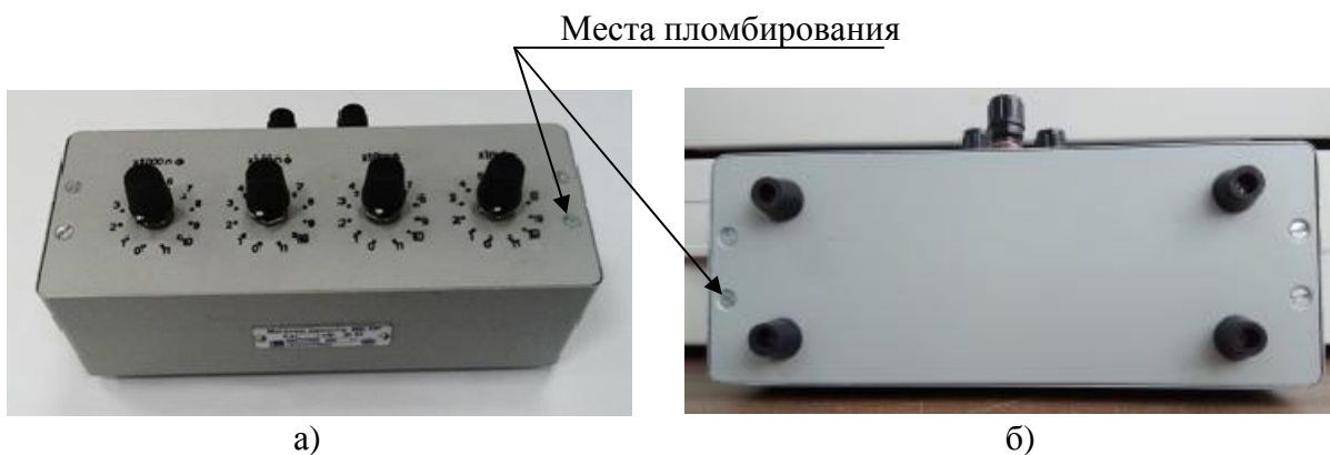
Рисунок 2 – Места пломбирования от несанкционированного доступа
