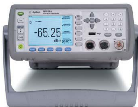
Рисунок 15 – Общий вид ваттметра 1914А, используемого совместно с преобразователями измерительными 8487А и 8487D
