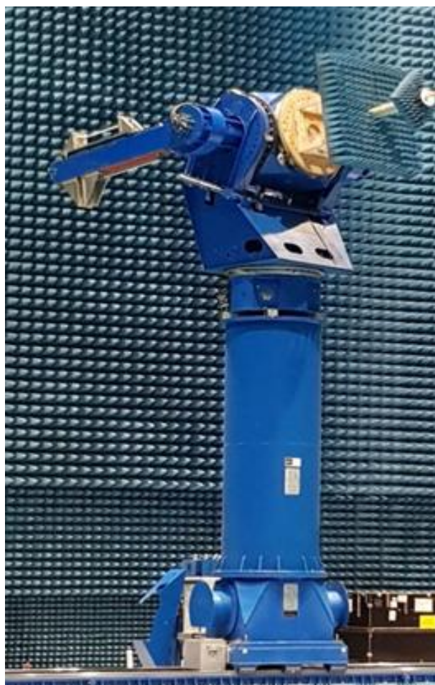
Рисунок 7 - Общий вид позиционера измеряемого объекта в коллиматорном режиме из состава ТМП 0515002 (опорно-поворотное устройство) в радиобезэховой экранированной камере ТМ ЭК 42.0x28.3x18.0
